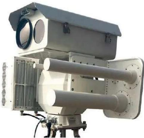
Визуальный способ обнаружения – один из самых слабых и уязвимых способов. Однако позволяет выявить аппараты на подлете к цели. Особенно, если это дрон-камикадзе. Для обнаружения БПЛА в оптическом диапазоне электромагнитных волн существуют активные и пассивные методы. Активными методами считается метод анаглифов и метод определения координат БПЛА в пространстве. Пассивные методы включают в свой состав метод визуального наблюдения и метод комбинированного стереоэффекта.
